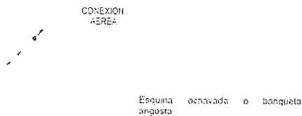
Se debe mantener el mismo lado de la acera para todas las líneas, longitudinal y transversalmente. Para instalar postes en las esquinas, seleccione la acera del lado de crecimiento de la ciudad para evitar anclajes con estacas.
