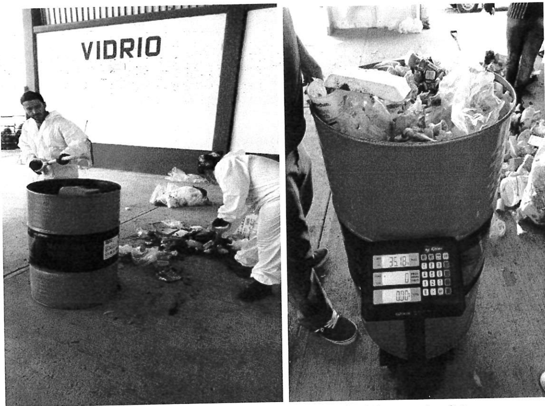
Imagen IV.1- 15 Procedimiento para la obtención del peso volumétrico.
